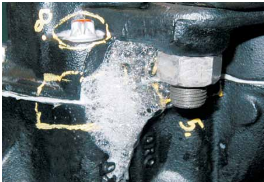
Schaum zeigt Undichtheit: Werden Sattelgehäuse einmal geöffnet, sind Leckagen programmiert. Korrosion und Ausfall folgen.
