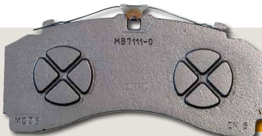
Neuer Bremsbelag mit Belagniederhaltesystem mit ProTec S ® und MB-Kennzeichnung.
