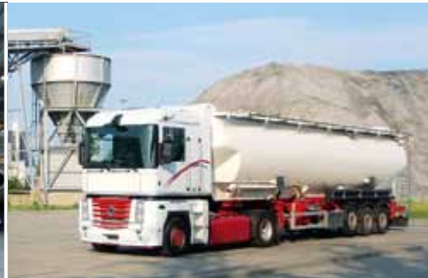
Behälterfertigung im Werk Winsen. Silosattelzug mit Feldbinder-Aufbau für Schüttgüter der Baubranche.
